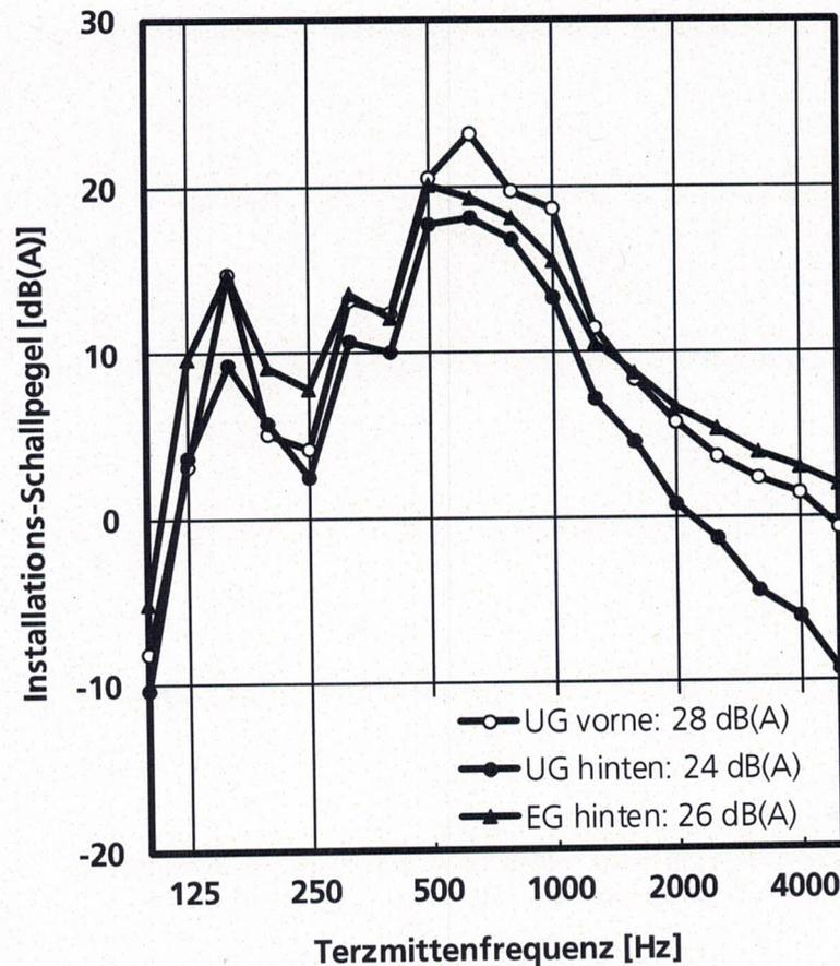
Frequenzverlauf des Installations-Schallpegels bei Geräuschanregung mit dem Körperschall-Geräuschnormal (KGN), gemessen in den Räumen UG vorne, UG hinten und EG hinten. In der Legende sind die Installations-Schallpegel  $L_{A\text{Feg},n}$  in dB(A) nach DIN 4109 für den abgebildeten Frequenzbereich von 100 bis 5000 Hz angegeben.
