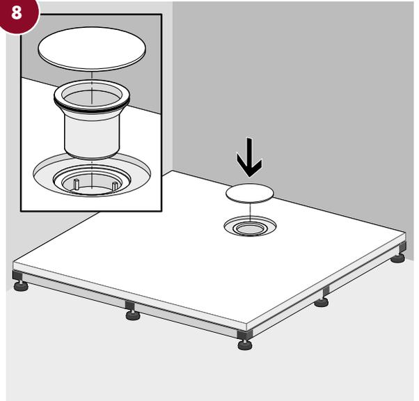
Siphoneinsatz eindrücken und mit Wasser füllen. Abdeckung aufstecken.
