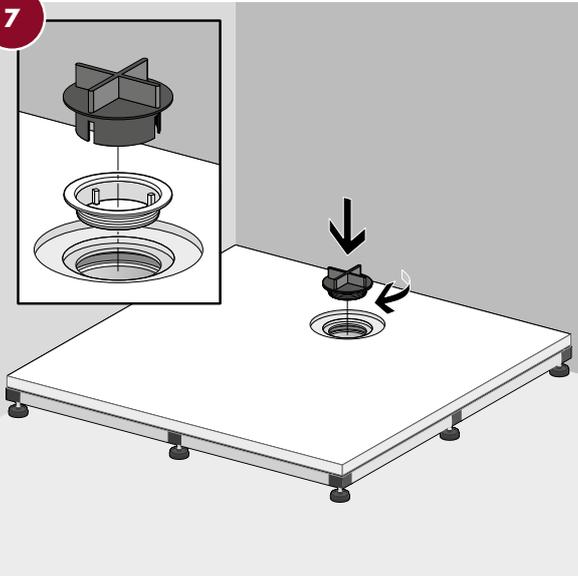
Siphonoberteil mit der Montagehilfe in den Siphon eindrehen und so mit der Duschwanne verschrauben.
