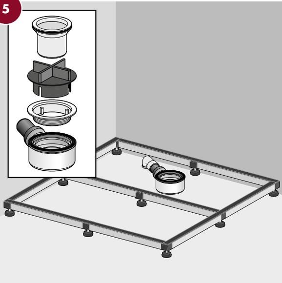
Siphon montieren und anschließen.
