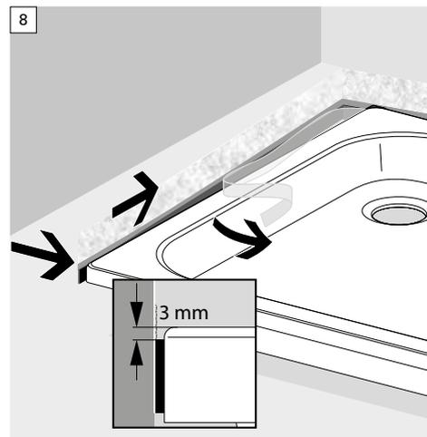
Schutzfolie abziehen, Wannendichtband unter leichtem Zug bündig mit 3 mm Abstand von oben auf den Wannenrand kleben.
