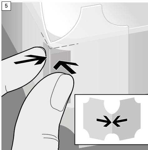
Zum Modellieren der Füllstücke benutzen Sie die beschichteten Radiusschablone.
