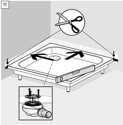
Ablaufgarnitur montieren, Dusch-/Badewanne an der Einbaustelle positionieren und ausrichten. Enden des Wannendichtbandes bündig abschneiden.
