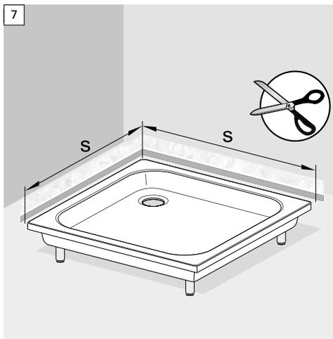
Wannendichtband auf erforderliches Maß ablängen und an beiden Enden ca. 2 cm zugeben.
