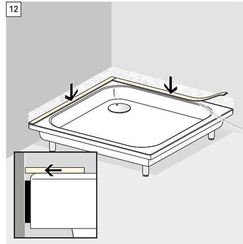
Distanzband ablängen und bündig zum Wannenrand bzw. anstoßend an das Wannendichtband aufkleben.
