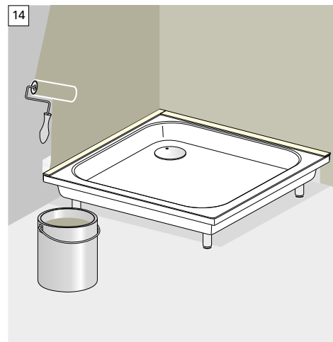
Anschließend Wannendichtband an die Wand anlegen und überrollen/überstreichen.
