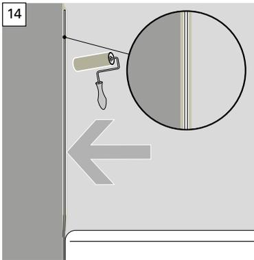
Das Wannendichtband ist somit in das Abdichtungsmaterial eingebunden.
