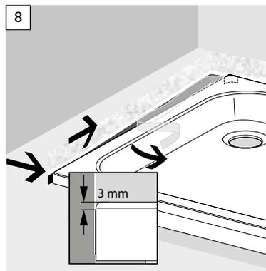
Schutzfolie abziehen, Wanddichtband unter leichtem Zug bündig mit 3 mm Abstand von oben auf den Wannenrand kleben.
