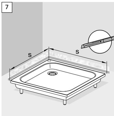
Wanddichtband auf erforderliches Maß ablängen und an beiden Enden ca. 2 cm zugeben.
