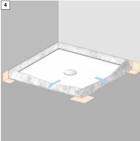
Vorbereitete Duschwanne mit eingebautem Estrich.
