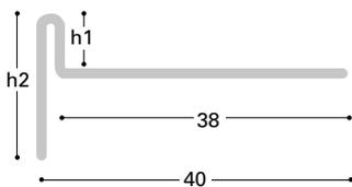
Materialstärke des Profils: 0,8 mm
