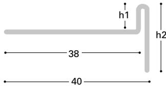
Materialstärke des Profils: 0,8 mm
